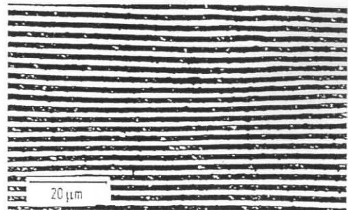
Bild 7.8. Gerichtet erstarrtes Eutektikum einer eutektischen Al—Cu-Legierung (hell: Al-Mischkristall, dunkel:  $\text{Al}_2\text{Cu}$ )
