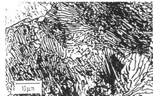
Bild 3.14. Perlit in Stahl mit 0,8 % C als Beispiel für ein eutektoides Gefüge
