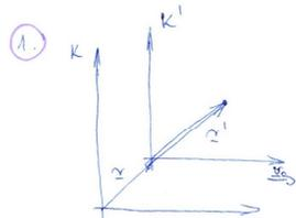
$$\left. \begin{aligned} x' &= x - v_x \cdot t \\ y' &= y - v_y \cdot t \\ z' &= z - v_z \cdot t \\ (t' &= t) \end{aligned} \right\} \text{Galilei-féle transzformáció}$$
