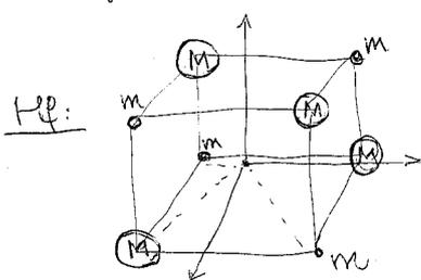
$$\underline{\Theta} = \begin{bmatrix} 6(m+M)a^2 & 2(M-m)a^2 & 0 \\ 2(M-m)a^2 & 6(m+M)a^2 & 0 \\ 0 & 0 & 6(m+M)a^2 \end{bmatrix}$$
