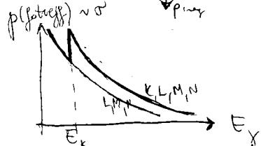
c) fotoeff. rendszámfüggése: nagyobb rendszám esetén nagyobb a fotoefektus valószínűsége virtuális foton, amit a gyorsan mozgó koordinátarendszerben érzékelünk az em teljesi
