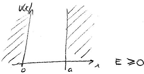
$$-\frac{\hbar^2}{2m} \Psi''(x) + V(x)\Psi(x) = E\Psi(x) \quad \text{időtől független Schrödinger egyenlet}$$
