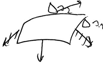
$$F_{\perp \text{össz}} = \alpha \left( \frac{1}{R_1} + \frac{1}{R_2} \right) \underbrace{\Delta\sigma_1 \Delta\sigma_2}_{\text{a felület nagysága}}$$
