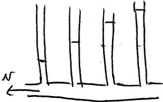
a víz áramlik, de a vízint <sup>(N)</sup> csökken a cső mentén
