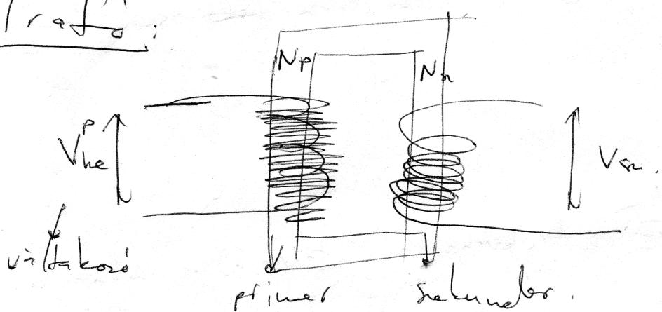
Voltmeter an  $V_p \Rightarrow$  sekundärspannung für vorgegebene Flussänderung  $\rightarrow$  sekundärspannung proportional induktivität
